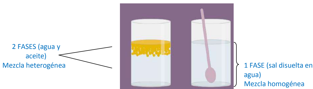
Figura 1: la mezcla de agua y aceite es heterogénea ya que en ella se pueden distinguir dos fases, una correspondiente al agua y la otra al aceite. En la mezcla de agua y sal no se pueden distinguir distintas fases ni componentes, ya que los mismos se mezclan en todas sus proporciones.
